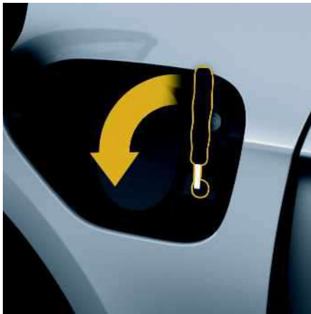
Рис. 55: Аварийная разблокировка механической крышки зарядного разъема
