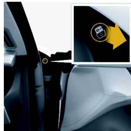
Рис. 57: Аварийная разблокировка автомобильного зарядного штекера
