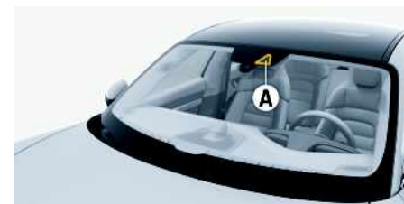
Рис. 101: Камера на лобовом стекле
