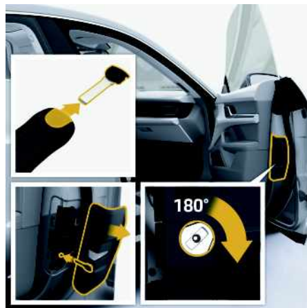
Рис. 228: Аварийное запирание двери переднего пассажира
