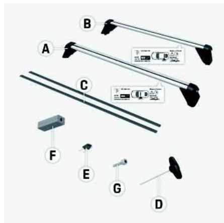
Рис. 181: Компоненты системы транспортировки на крыше
