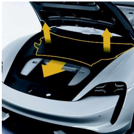
Рис. 27: Снятие и подъем пластмассовой обшивки
