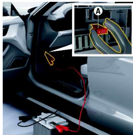
Рис. 118: Аварийное отпирание передней крышки — подключение плюсовой клеммы
