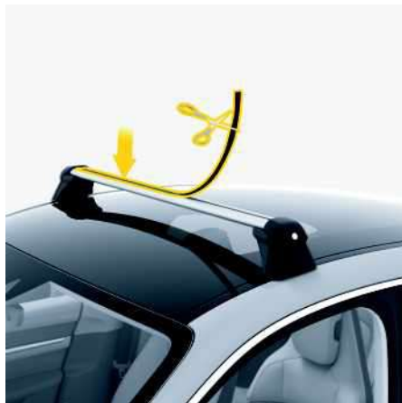
Рис. 195: Обрезка и установка защитного профиля
