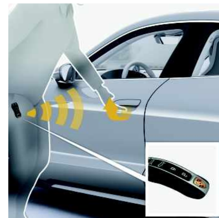
Рис. 223: Отпирание дверей с помощью системы комфортного доступа
