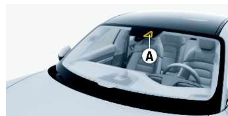
Рис. 161: Камера на лобовом стекле
