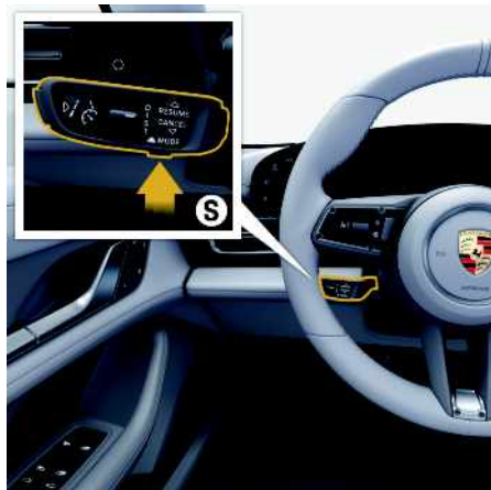
Рис. 22: Переключатель систем помощи водителю
