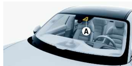
Рис. 132: Камера на лобовом стекле
