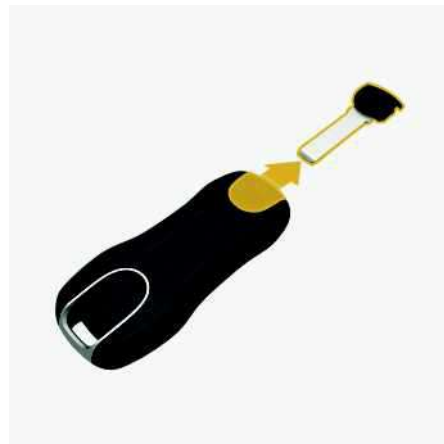
Рис. 64: Извлечение аварийного ключа
