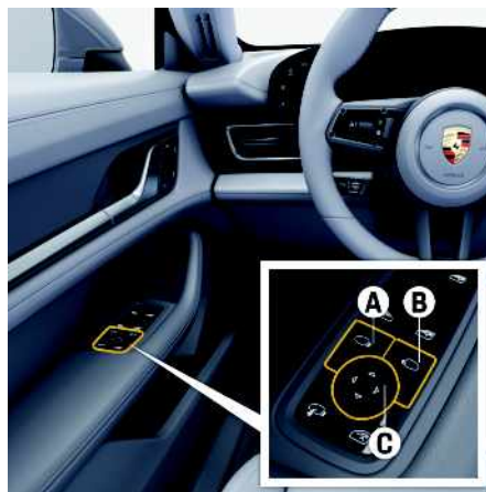
Рис. 61: Наклон стекла зеркала вниз для облегчения парковки
