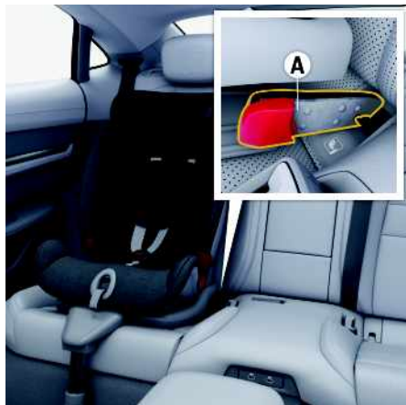
Рис. 207: Установка системы фиксации детских сидений с опорой
