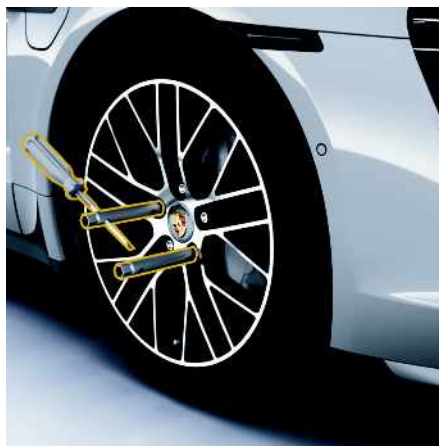
Рис. 235: Прикручивание двух монтажных приспособлений на автомобилях с РССВ
