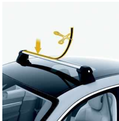
Рис. 193: Обрезка и установка защитного профиля
