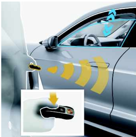
Рис. 33: Опускание и подъем боковых стекол ключом автомобиля
