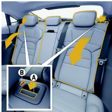
Рис. 157: Складывание спинок боковых задних сидений
