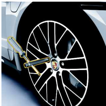
Рис. 234: Прикручивание одного монтажного приспособления на автомобилях с РССВ
