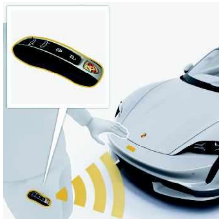
Рис. 116: Открывание передней крышки с помощью системы комфортного доступа
