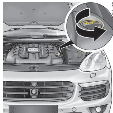
Заливная горловина для долива масла в двигатель, Cayenne S Diesel
