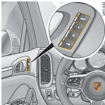
Кнопки памяти в двери водителя (с обычной функцией памяти или функцией памяти Comfort)
