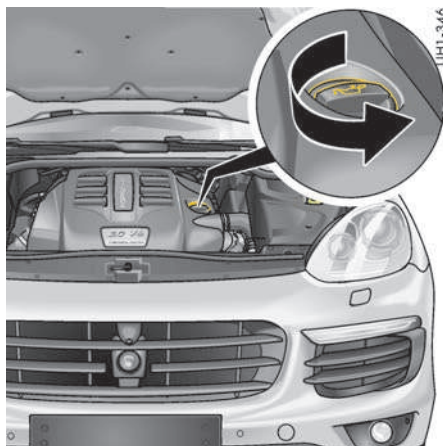
Заливная горловина для долива масла в двигатель, Cayenne Diesel
