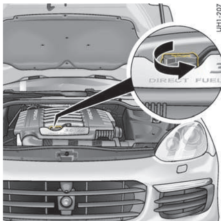
Заливная горловина для долива масла в двигатель, Cayenne
