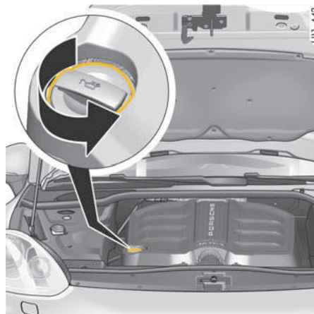
Заливная горловина для долива масла в двигатель Cayenne S, Cayenne GTS
