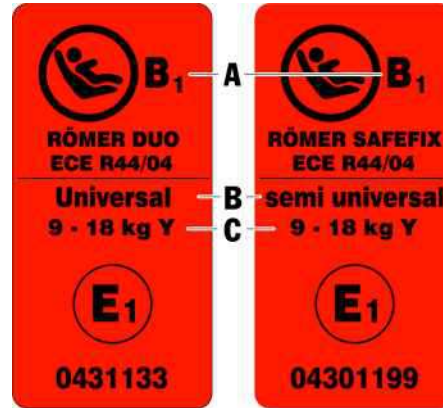
Рис. 184: Пример этикетки ECE системы фиксации детских сидений
