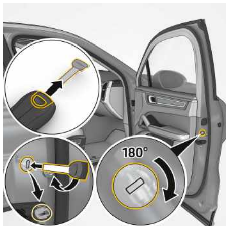
Рис. 222: Аварийное запираение двери переднего пассажира
