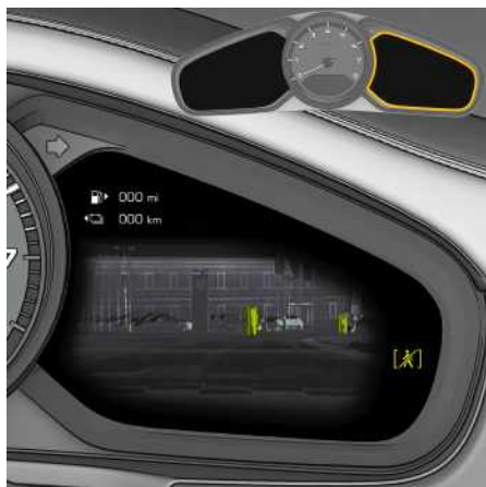
Рис. 155: Тепловое изображение системы ночного видения
