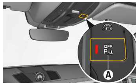
Рис. 166: Деактивация системы помощи при парковке
