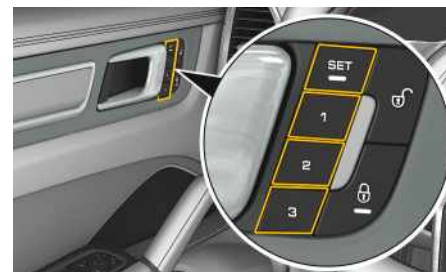
Рис. 104: Кнопки памяти индивидуальных настроек в двери водителя
