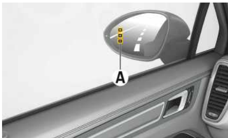
Рис. 168: Индикатор А в наружном зеркале заднего вида
