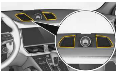
Рис. 56: Верхняя зона вентиляции
