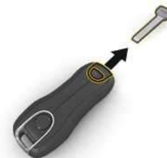
Рис. 48: Извлечение аварийного ключа
