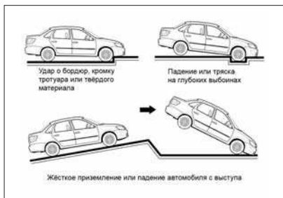
Рис. 15б. Примеры ситуаций со срабатыванием системы пассивной безопасности водителя и переднего пассажира
