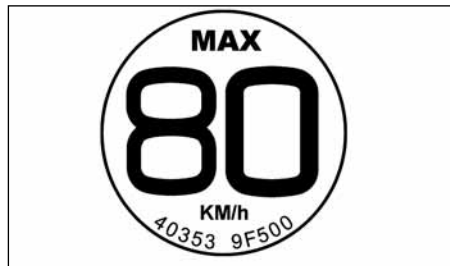
Маркировка малоразмерного запасного колеса, предназначенного только для временного использования
